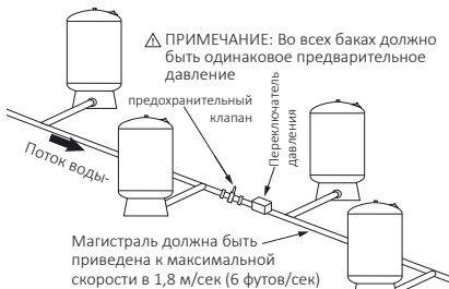
Рис. 1.5 Установка нескольких баков
